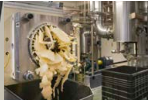
Trafila di estrusione dell'impianto di saponificazione.
